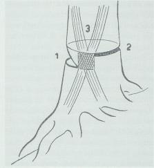
1. Schrot; 2. Sägeschnitt; 3. Bänder. Bild aus Schmitter 1953.
