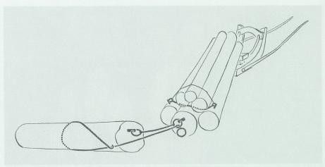
Der Guntler, zusätzlich an die Ladung gekettet, dient als Bremse. Bild aus Schmitter 1953.
