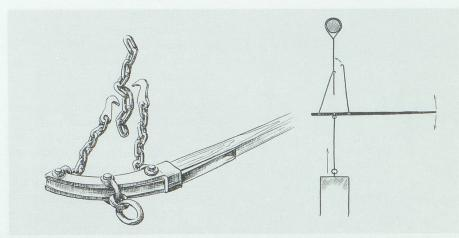
Der «Waldteufel», ein Gerät mit enormer Hebelkraft. Bild aus Schmitter 1953.
