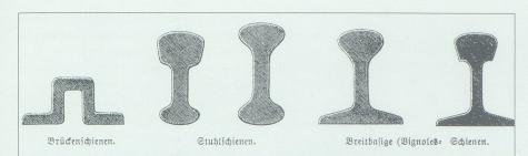
Abb. 11. Typische Schienenprofile um 1850. Darstellung aus Schweiger-Lerchenfeld 1894.
