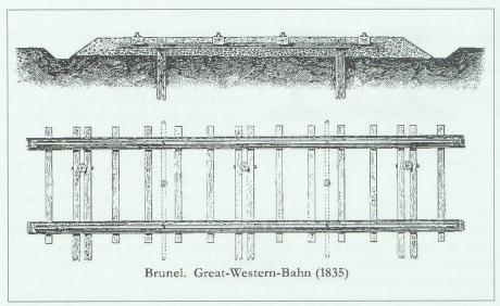
Abb. 14. Längsschwellen-Oberbau der Great Western. Darstellung aus Haarmann 1902.
