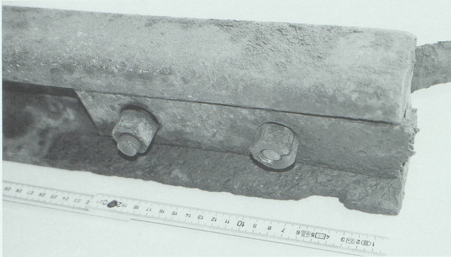
Abb. 7. Laschen und Laschenbolzen (Schiene 2).
