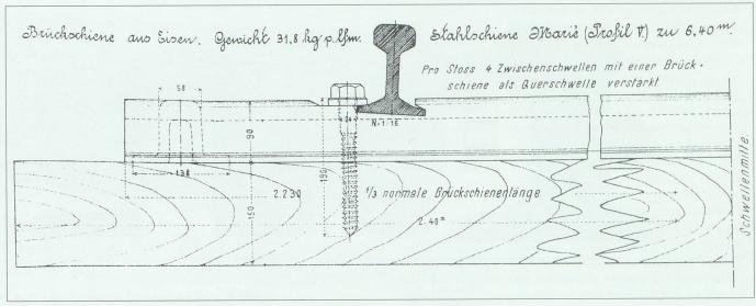
Abb. 10. Stossschwelle mit Brückenschiene verstärkt. Bild aus SBB 1912.
