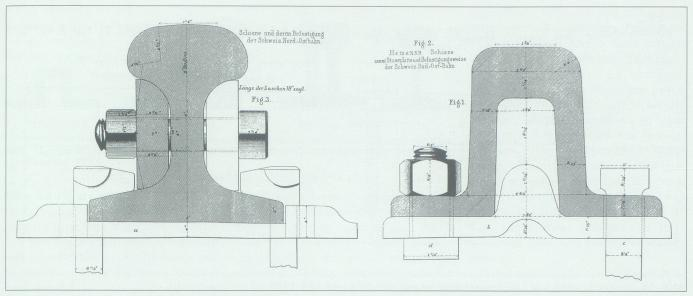
Abb. 9. Die zwei Profile im zeitgenössischen Vergleich. Links die NOB-Schiene (Vignolesschiene), rechts die SOB-Schiene (Brückenschiene). Darstellung aus Erlach 1855.
