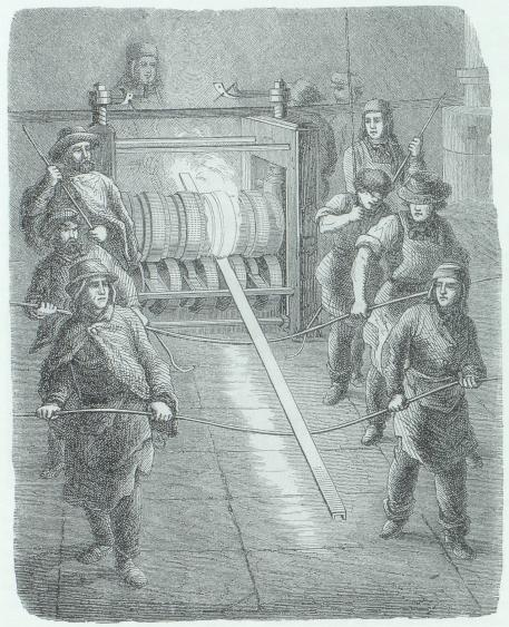
Abb. 17. Walzen von Eisenprofilen. Eine Schiene von 6 bis 7 Metern Länge und etwa 200 Kilogramm Gewicht entspricht dem Maximum, das auf diese Weise im Handbetrieb gewalzt werden kann. Bild aus Erfindungen 1864.
