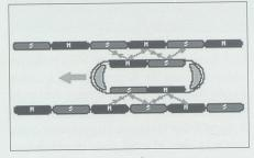
Das elektrodynamische Magnetsystem für das Tragen, Führen und Antreiben des Maglev ist im Rand der Fahrstrecke installiert.
