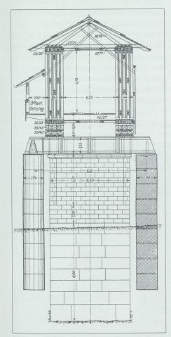
Querschnitt der Ragazer Brücke mit ins Flussbett eingelassenem Röhrenund Steinpfeiler. Darstellung aus Bühler 1928.
