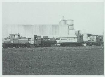
Alle werkeigenen Lokomotiven der Viscose auf einen Blick: die Diesellok «Ribel», die Dampfspeicherlok «Osterhase» und die Akku-Traktoren «Tram» und «Bügeleisen» (von links). Aufnahme von 1969 in Sammlung Anton Heer, Flawil.
