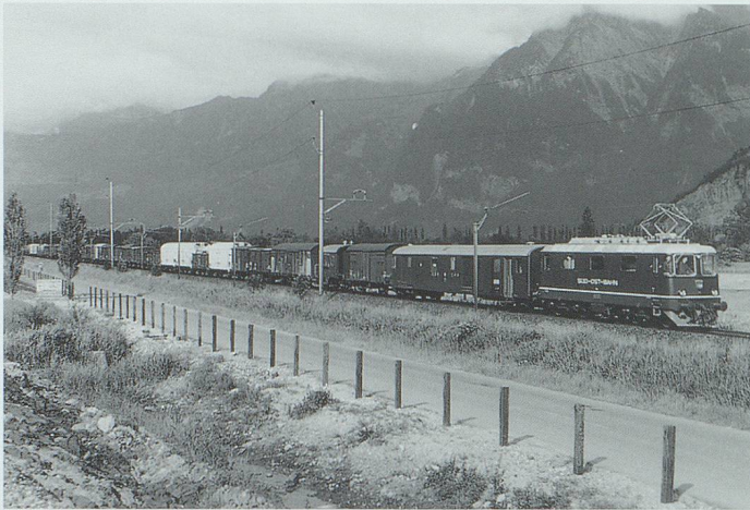
Ironie der Geschichte: «Süd-Ost-Bahn» auf der ursprünglich als Südostbahn geplanten Rheintallinie. Ablieferungs-Last-Probefahrt einer Re 4/4 41 der SOB im Juni 1967 vor Sargans. Bild: Daniel Heer, Zürich.
