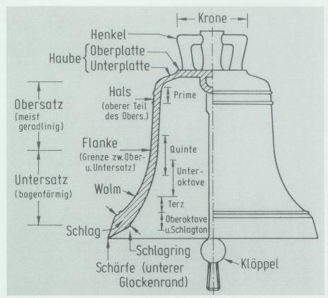
Aufbau einer Glocke. Bild aus Niemann 1984, S. 448.
