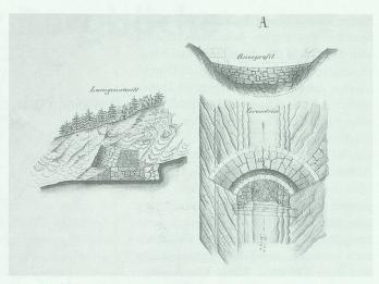
Diese Sohlensicherung im Trüebbach mit bogenförmigem Trockenmauerwerk wurde 1862 vom Wasserbauinspektor Hefti entworfen. Plan im Staatsarchiv St.Gallen.
