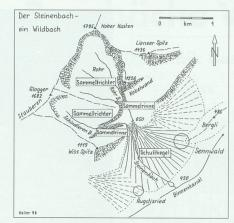
Figur 4: Der Steinenbach mit seinen zwei Quellästen weist in mustergültiger Art und Weise die Hauptmerkmale von Wildbächen, nämlich die drei Abschnitte Sammeltrichter, Sammelrinne und Schuttkegel auf.
