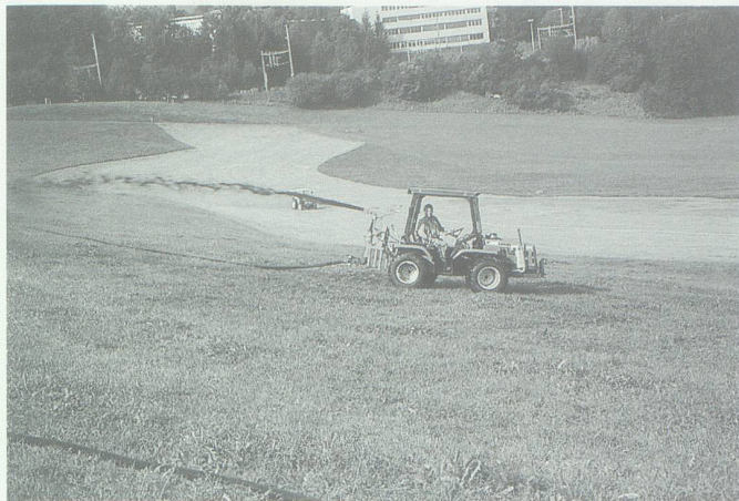
Abb. 5. Die mechanisierte Gülleverschlachtung bietet heute für arrondierte Betriebe oder hofnahe Parzellen eine Ausbringtechnik für Gülle, die sich durch hohe Leistung und Bodenschonung auszeichnet: Die Böden müssen nicht mit schweren Druckfässern befahren werden.
