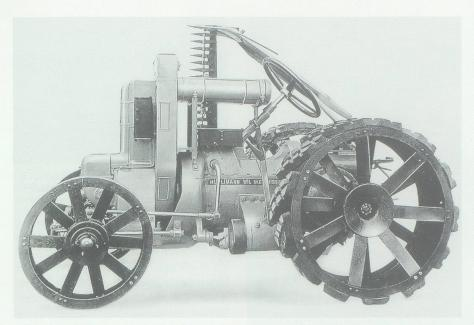
Der erste Hürlimann-Traktor 1 K 8 mit Einzylinder-Bernard-Motor R 3, Baujahr 1929/30. Bohrung 90 mm; Hub 120 mm; Hubraum 763 cm³; Leistung 8,21 PS bei 1200 U/min; 3 Vorwärtsgänge, 1 Rückwärtsgang. Es wurden insgesamt 102 Traktoren 1 K 8 gebaut. Bild aus Morgenegg 1993.
