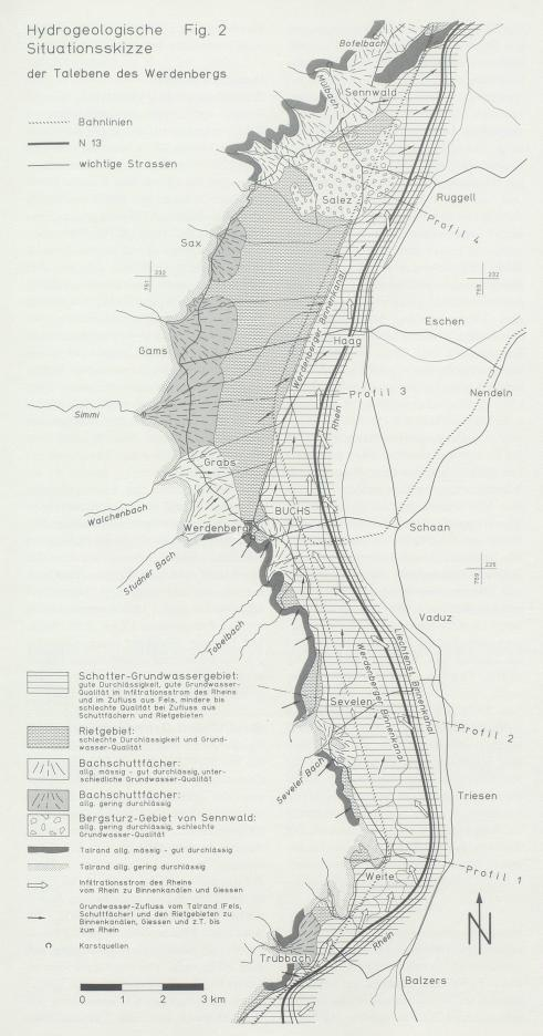
siltigen Grundmasse eingebettet, so dass die mittleren Durchlässigkeiten bei  $1\times10^{-6}$  bis maximal  $1\times10^{-4}$  m/s liegen und die Bergsturzmasse gesamthaft kein nutzbarer Grundwasserleiter ist.
