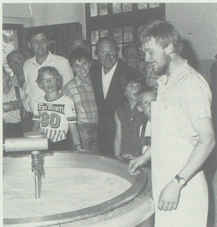
Einzug der Technik in der Sennerei: elektrisches Käserührwerk auf der Alp Tesel.
