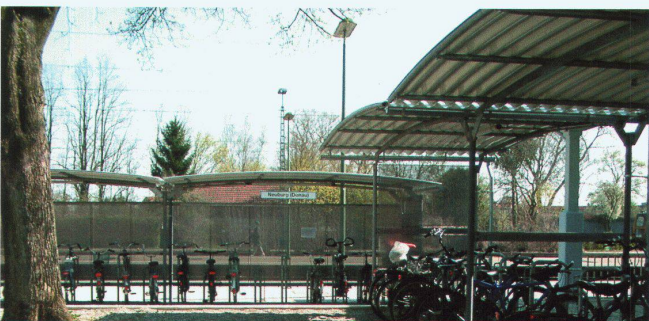
Überdachung einseitig, Wände aus Lochblech (nichtrostender Chrom-/Edelstahl).
