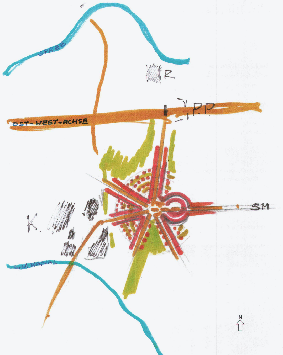
Skizze des Situationsplans und Querschnitt durch den Strassenraum. Die sternförmig verlaufenden Hauptstrassen sind leicht ansteigend, um den Potsdamer Platz topographisch zu akzentuieren. Die Strasse selbst schlüsselt den Verkehr in verschiedene Träger und Geschwindigkeiten auf. Esquisse du plan de situation et coupe transversale sur la rue. Les rues principales rayonnantes sont légèrement ascendantes pour accentuer topographiquement la Potsdamerplatz. La rue elle-même décode le trafic selon divers supports et vitesses. Sketch of the site plan and cross section of the street area. The main roads arranged in a star shape ascend gently in order to accentuate the Potsdamer Platz. The road itself separates the traffic according to load and speed.
