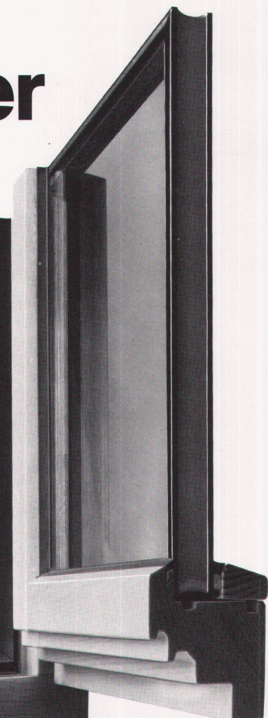
Das EgoKiefer Mitteldichtungssystem, die druckausgeglichene äussere Falzzone, MOBILE Rahmenwetter-schenkel, ein rundum laufender Beschlägefalz sowie zwei Tropfnasen machen die EgoKiefer Holz/IV-Fenster wirklich schlagregensicher.
