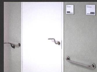
Der Türdrücker *FSB 1287* eliminiert den physischen Kontakt mit der Hand und sorgt für erhöhten Infektionsschutz sowie eine neu gewonnene Freiheit der Hände. Zur Betätigung liegt der Unterarm auf dem abgewinkelten Ende des Drückers – dem *Return* – auf. Die Bedienung ist unabhängig von der Zugangsrichtung (links- oder rechtskommend) möglich. Neben einer sicheren Betätigung bleiben die Hände frei für den Transport medizinischen Equipments, das Tragen eines Tablets oder sonstiger Arbeitsgeräte.
