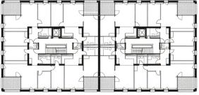
Die inneren und äusseren Mauern der Kerne sind wie die Aussenwand aus Steinblöcken gefügt, der Grundriss bleibt frei einteilbar.
