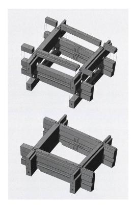
Konstruktionsmuster Swatch-Hauptsitz mit allen Lagen und Anschlüssen. Bild: Blumer-Lehmann
