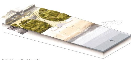
Die Verbindung von Düne, Deich und Tiefgarage machte es möglich, das Schutzbauwerk niedrig zu halten und die Sicht aufs Meer zu sichern.
