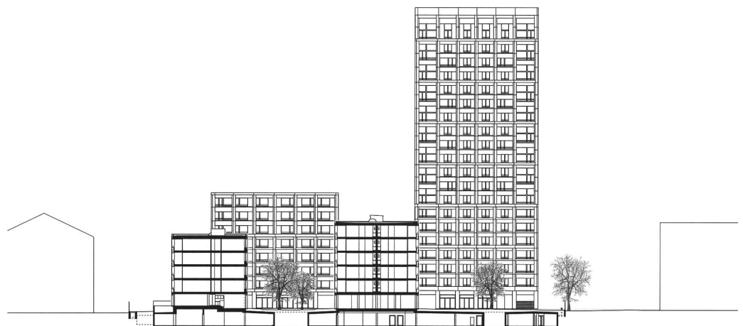
Querschnitt mit Aussparungen in der Tiefgarage für die Bäume
