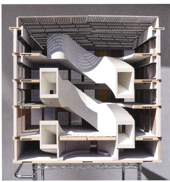
Die technische Lösung schafft den Raum: nicht nur mit der Doppelhelix der Treppen, sondern auch mit den Lüftungskanälen über den Garderoben. Modellbild: Pool Architekten
