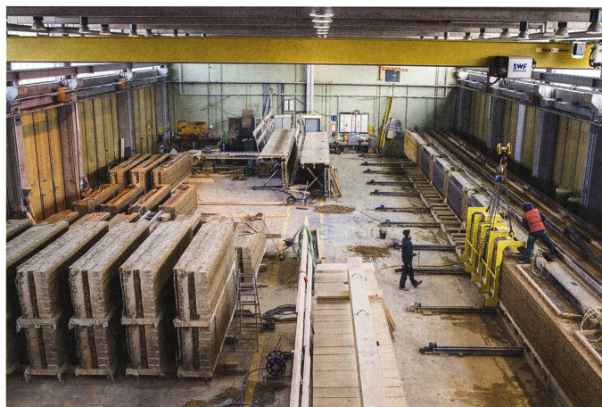
Vorfabrikation der Stampflehmelemente Bild: Emmanuel Dorsaz / Lehm Ton Erde Baukunst
