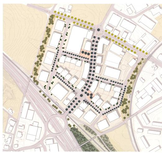
Im Richtprojekt sind die Nutzungen gemäss ihrem Erschliessungsbedarf verteilt. Von Bäumen gesäumte Strassen dienen als Rückgrat. Entlang der Ränder und der Bahn verlaufen Langsamverkehrsrouten.
