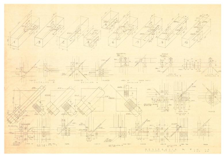
Gleich dimensionierte Stäbe sind in den Knoten mittels verschraubter Metallteilchen miteinander und mit den Zugstangen verbunden. Helio Olgas Firma Itaconstrutora ist auf industrielle Systembauweisen in Holz spezialisiert.
