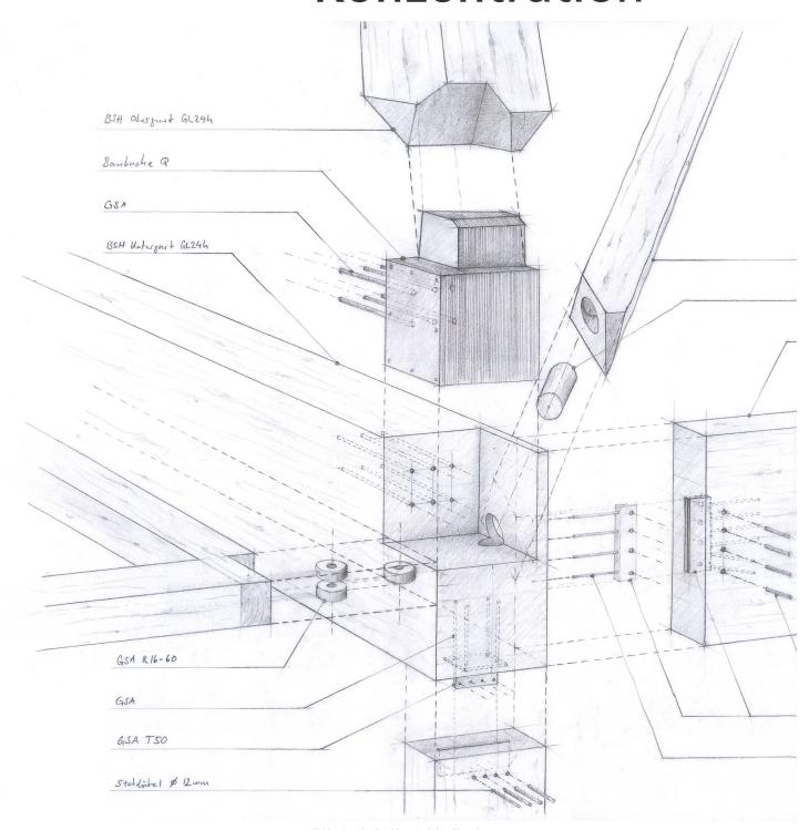
Eckknoten der Dachkonstruktion über dem Verpflegungsraum im «Condirama» des Firmensitzes Max Felchlin, an jener Stelle, wo die Kräfte aus dem Dach und dem Fachwerkausleger in die Stütze eingeleitet werden. Der Kräfteverlauf durch Stäbe und Hartholz-Einsatz ist auf Seite 16 dargestellt. Zeichnung: Lukas Eschmann
