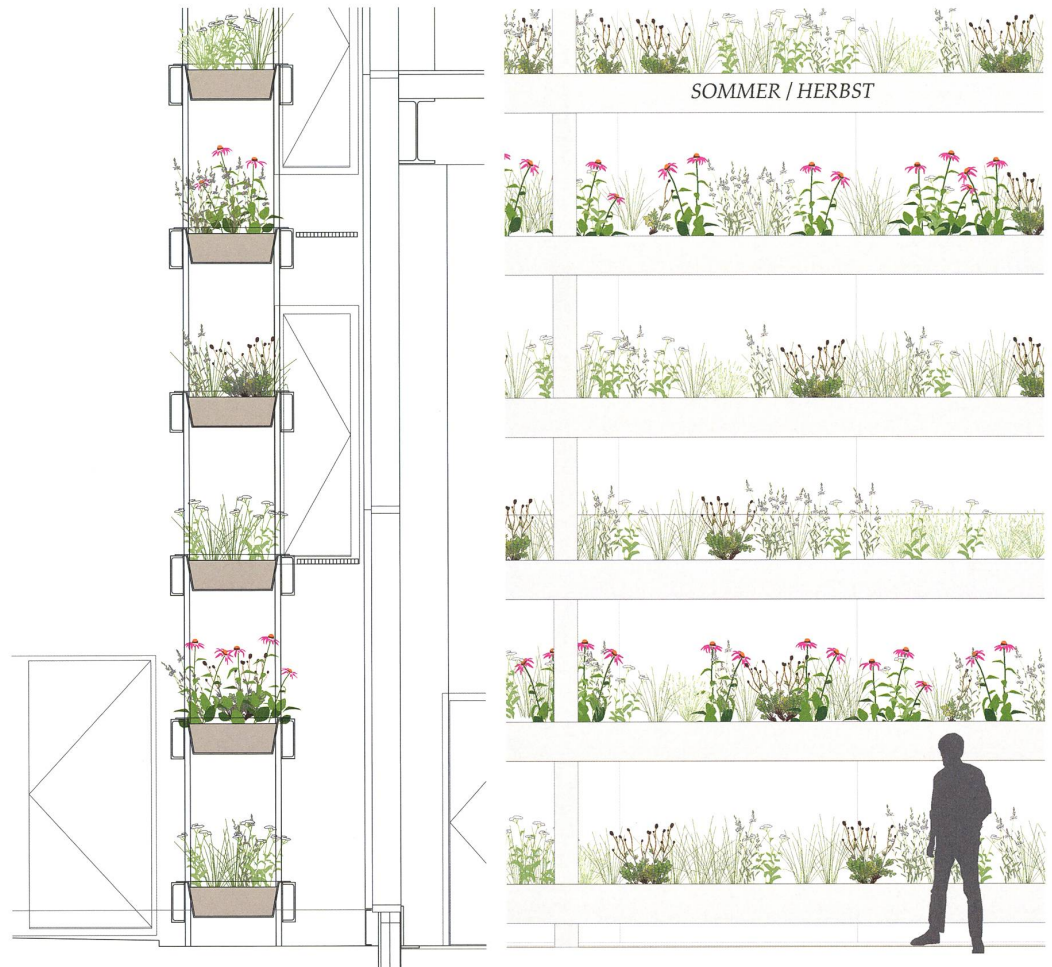
Ein frei stehendes Regal vor der Fassade des Gewerbebaus trägt den hängenden Garten, Pflegegänge erleichtern den Unterhalt.
