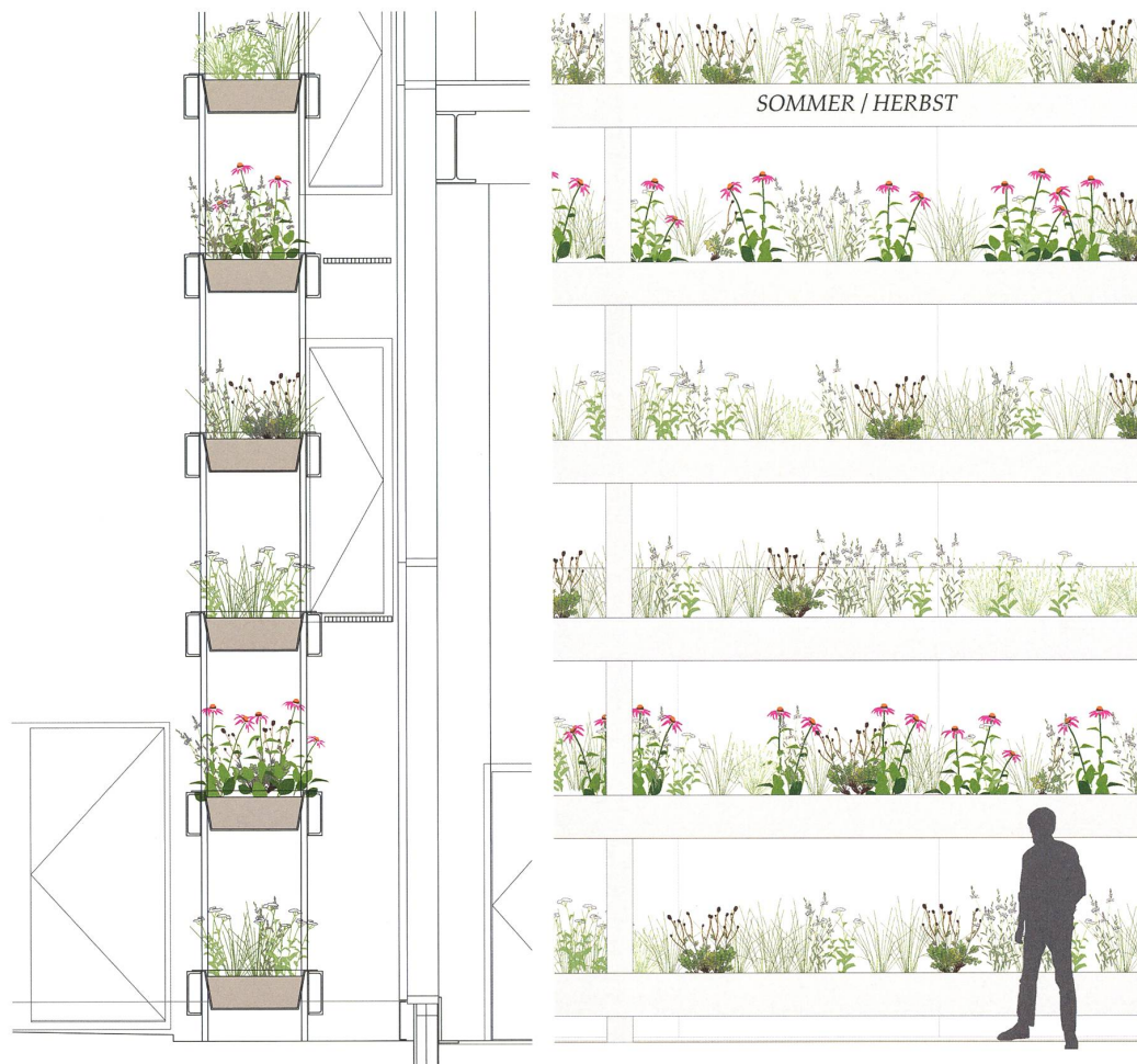
Ein frei stehendes Regal vor der Fassade des Gewerbebaus trägt den hängenden Garten, Pflegegänge erleichtern den Unterhalt.
