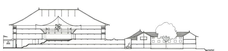
an Materialien - verputztes Mauerwerk, Bruchstein und ausladende Schrägdächer mit halbrunden Tonziegeln auf gewellten Zementplatten. Das Budget sah nur ein Minimum an Klimaanlagen vor, und die Gebäude mussten selbstkühlend sein. Um wegen der grossen Zahl ähnlicher Gebäude Monotonie zu vermeiden, variierte Bawa die Proportionen und die Detaillierung.
