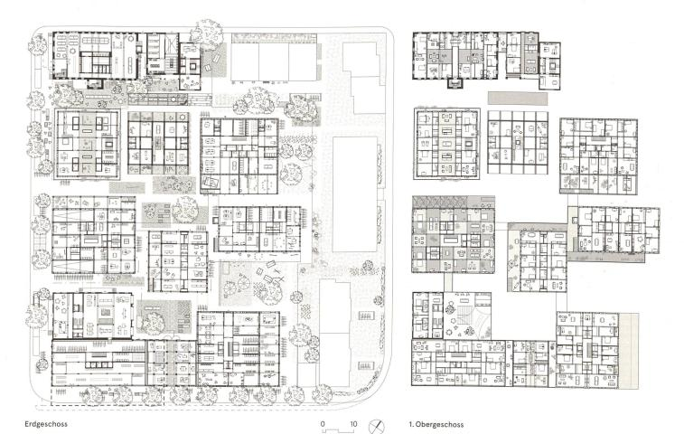
Die schachbrettartige Anordnung der bis zu siebengeschossigen Neubauten erreicht eine Kleinräumigkeit im Freiraum und eine grosse Durchlässigkeit in alle Richtungen. Grundrisse und Raumdispositionen sind aber im Einzelfall noch schematisch.
