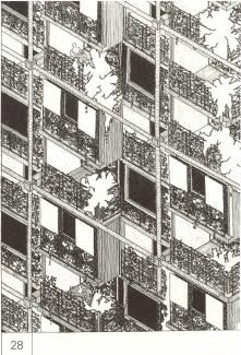
Do-it-yourself und Modularität als einigende Prinzipien für eine Lagerhalle und ein Scheibenhochhaus. Elemente und raumhaltige Fassade testete der Architekt Zalotay beim Bau seines eigenen Wohnhauses. Ausrisse aus einem Buch im Eigenverlag, 1976.
