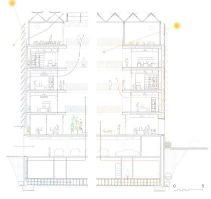
Die (durch eingelegte Lüftungskanäle aktivierte) Trägheit der Massivkonstruktion bewirkt zusammen mit der ausgeklügelten Steuerung der Luftzirkulation
