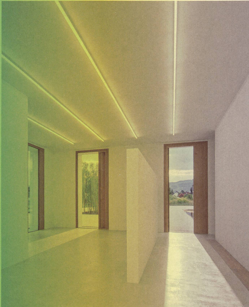
Im Bau 2226 in Lustenau von Baumschlager Eberle bleibt die Raumtemperatur ohne Haustechnik stets zwischen 22 und 26 Grad. Um den Wärmeeintrag zu minimieren, bestehen die Fassaden nur zu 20 Prozent aus Fenstern. Diese sind innen an den 76 cm starken Wänden angeschlagen. Damit Licht tief ins Gebäude dringt, sind sie raumhoch und verfügen über Wannen in den Laibungen, über die bei Regen Licht in den Raum reflektiert wird. Sensoren messen Temperatur, Feuchtigkeit und CO 2 -Gehalt der Luft in den Räumen, eine Software ermittelt, wann welche Lüftungsflügel geöffnet und geschlossen werden sollen. Bild: archphoto, Baumschlager Eberle Architekten
