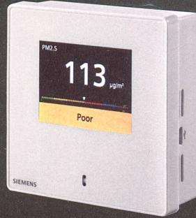
Der neue, auf Lasertechnologie basierende Feinstaubsensor von Siemens misst die Belastung der Luft im Gebäude mit Feinstaubpartikeln der Größen Particulate Matter (PM) 2,5 und PM 10, also Schwebeteilchen mit einem Durchmesser von 0,3 bis 2,5 Mikrometer bzw. 0,3 bis 10 Mikrometer. Als Einsatzgebiete für den neuen Feinstaubsensor kommen vorwiegend Büro- und hochwertige Wohngebäude in Frage.
