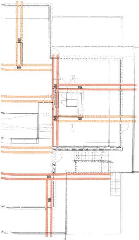
Überschiebungen am Geländesprung. Das Tragwerk ermöglicht eine freie Anordnung der Bodenebenen und die flexible Nutzung der einzelnen Geschossflächen. Die Asymmetrien des Baukörpers geben dem Firmenhauptsitz einen repräsentativen Ausdruck. Bild: Stefan Kunz
