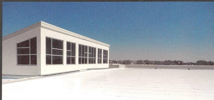
*Sopraplastar* entspringt dem Know-how von Soprema, weltweit führend auf dem Gebiet der Abdichtung. Ihr grösster Trumpf ist die Kühlhaltung von Bedachungen, die mithilfe eines hohen solaren Reflexionsvermögens von 0,78 und thermischen Emissionsgrads von 0,89 erreicht wird.
