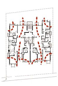
4. Obergeschoss mit Durchlüftungsschema
