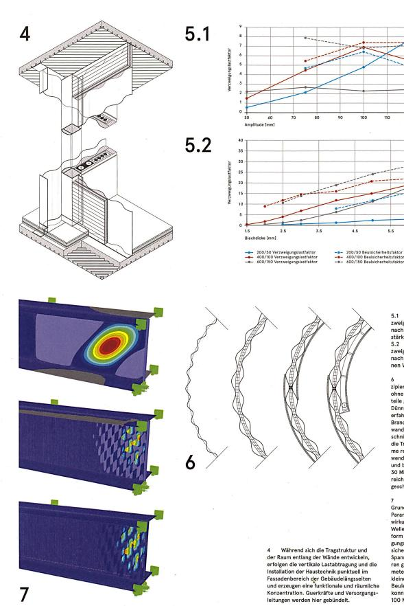
5.1 Auswirkung der Amplitude auf Verzweigungslastfaktoren und Beulsicherheit nach Theorie II. Ordnung bei einer Blechstärke von 3 mm
