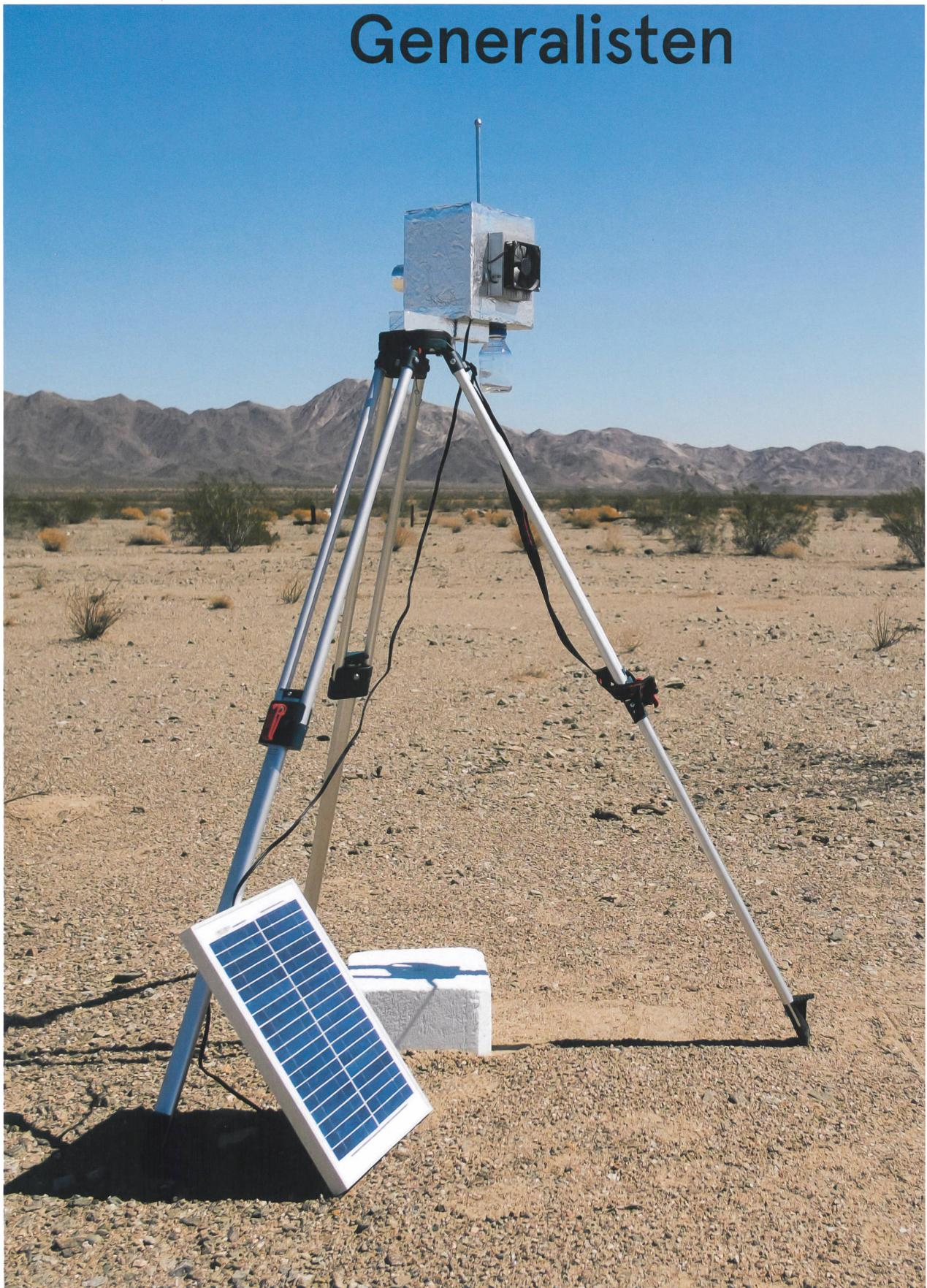
«Gletscher» in der Mojave-Wüste: Der Apparat sammelt die wenigen Wassermoleküle in der Luft und lässt sie durch Kondensation so abkühlen, dass sie zu Eis gefrieren. Bild: Valentin Kunik
