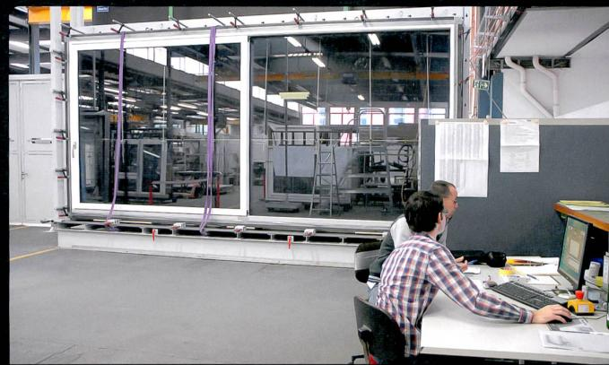
Laut den Produktenormen SN EN 14351-1+A1 müssen Fenster und Türen Mindestanforderungen hinsichtlich Luftdurchlässigkeit, Widerstandsfähigkeit gegen Windlast und Schlagregendichtheit erfüllen. Die Ernst Schweizer AG kann mit ihrem haus-eigenen Fenster- und Fassadenprüf- stand die dazu notwendigen, norm- getreu simulierten Prüfungen durch
