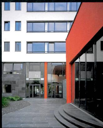
Den steigenden Anforderungen an den baulichen Wärmeschutz begegnet Jansen mit *Janisol HI*, einem hochwärmédämmenden Stahlprofil- system für Fenster und Türen. Mit seinen schmalen Ansichtsbreiten lassen sich vielfältige Fenster- und Tür- elemente sowie Festverglasungen herstellen.
