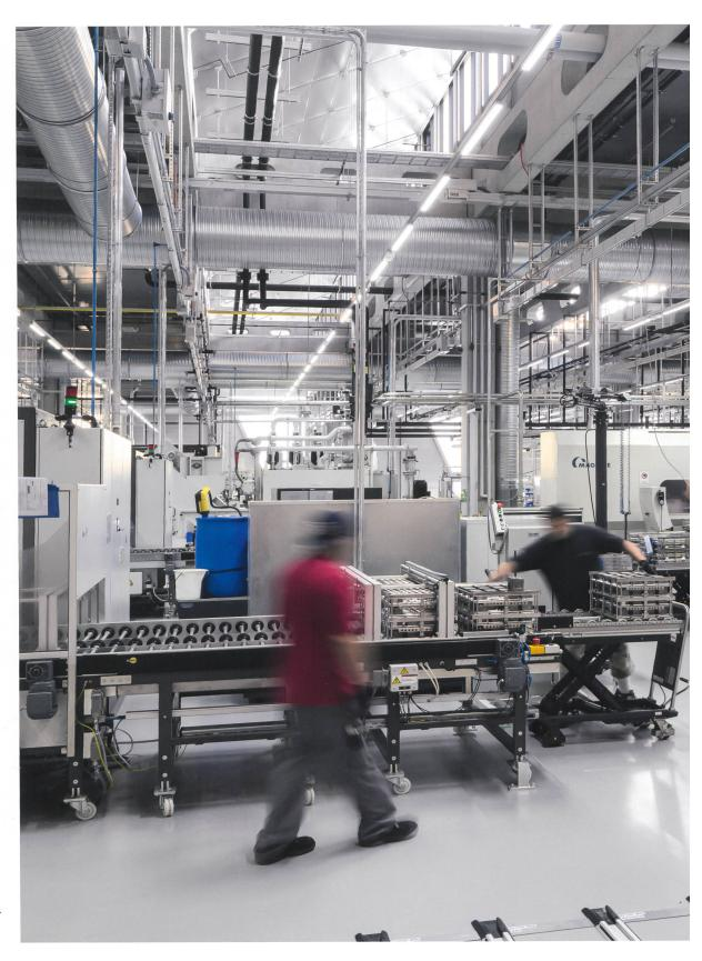
Nur noch wenige Menschen überwachen die Roboter und Automaten der Produktion von Hydraulik-Aggregaten in der lichten Weite der vier Shedhallen in Kaufbeuren.
