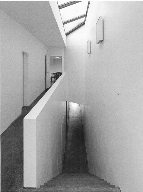
Durch das versteckte Oblicht gelangt Tageslicht bis zu den Garderoben im Untergeschoss.
