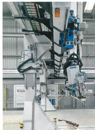
Der grösste Portalroboter Europas steht jetzt in der Schweiz. Mit dem Portalroboter produziert die Erne AG Holzbau zur Zeit die Dachkonstruktion für den Neubau Arch\_Tec\_Lab des ETH-Instituts für Technologie in der Architektur (ITA). Das Dach wird dereinst aus 45 000 einzelnen Elementen bestehen, welche vom Portalroboter vollautomatisch zu einem freigeformten Holzdach verwoben werden. Dabei optimiert die Anlage den Holzverbrauch und die
