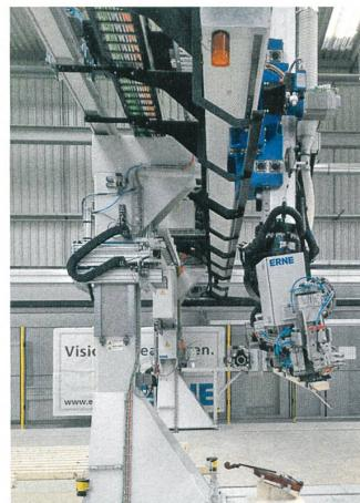
Der grösste Portalroboter Europas steht jetzt in der Schweiz. Mit dem Portalroboter produziert die ERNE AG Holzbau zur Zeit die Dachkonstruktion für den Neubau Arch\_Tec\_Lab des ETH-Instituts für Technologie in der Architektur (ITA). Das Dach wird dereinst aus 45 000 einzelnen Elementen bestehen, welche vom Portalroboter vollautomatisch zu einem freigeformten Holzdach verweben werden. Dabei optimiert die Anlage den Holzverbrauch und die
