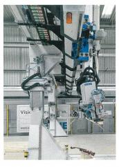
Der grösste Portalroboter Europas steht jetzt in der Schweiz. Mit dem Portalroboter produziert die Erne AG Holzbau zur Zeit die Dachkonstruktion für den Neubau Arch\_Tec\_Lab des ETH-Instituts für Technologie in der Architektur (ITA). Das Dach wird dereinst aus 45 000 einzelnen Elementen bestehen, welche vom Portalroboter vollautomatisch zu einem freigeformten Holzdach verwoben werden. Dabei optimiert die Anlage den Holzverbrauch und die
