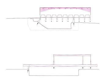
Vier Hauptstützen tragen die Längswände der oberen Trainingshalle, an denen wiederum die Durchlaufträger der unteren Wettkampfhalle aufgehängt sind. Die horizontale Aussteifung erfolgt über die Decke der Wettkampfhalle mit Verankerung im
