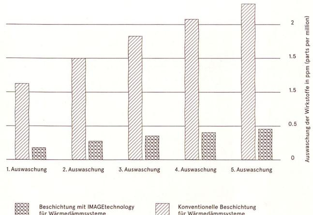
das Wachstum von Algen und Pilzen. Um dem entgegenzuwirken, werden konventionelle Fassadenbeschichtungen mit bioziden Wirkstoffen ausgestattet. Damit Biozide wirksam sein können, müssen sie wasserlöslich sein. Dies hat den Nachteil, dass die eingesetzten Wirkstoffe durch Regenwasser ausgewaschen werden und ins Grundwasser gelangen können. Auf dem Markt werden seit einigen Jahren biozidfreie Fassadenbeschichtungen angeboten, jedoch sind
