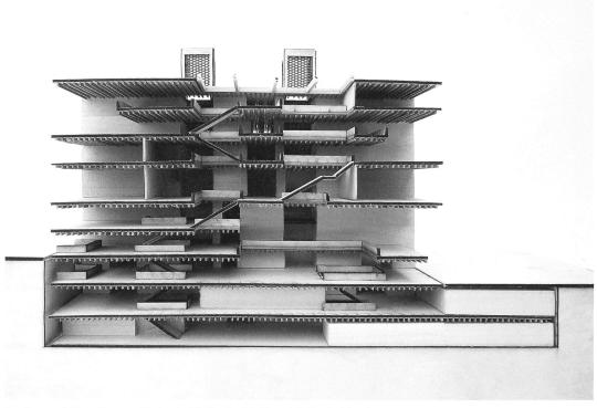
Das Siegerprojekt von Enzmann Fischer Architekten im Schnittmodell: Eine funktionale Box nach Design-to-Cost-Vorgabe mit differenzierter Erschliessung.
