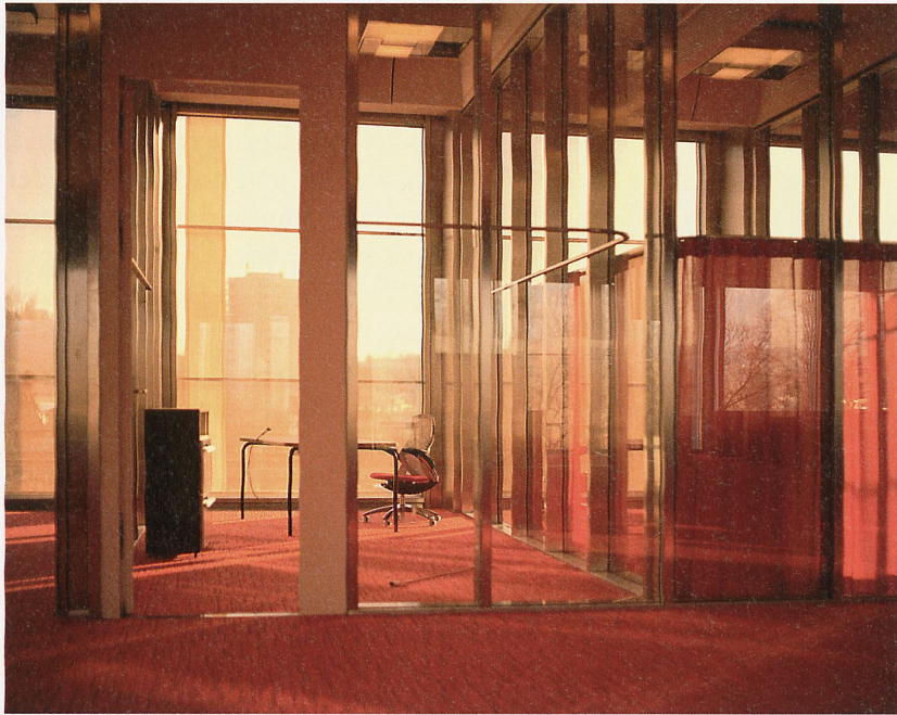
Eine aussergewöhnliche Raumhöhe von über vier Metern, Trennwände aus Glas und optische Trennungen wie Vorhänge zeichnen die Bürogesschosse aus.
