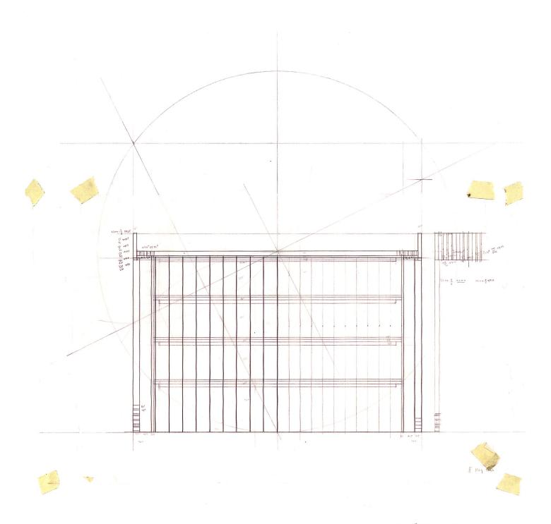
Masszeichnung von Peter Märkli: Über dem Quadrat mit der Gebäudetiefe von 32 Metern werden das Triangulum (%) und der Goldene Schnitt konstruiert. Anders als die angenäherte Zahl ist die analog konstruierte Geometrie exakt.
