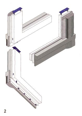
3D-Kontrollplan für den Verlauf der Kompribänder; Dichtigkeitskontrolle der werden.
