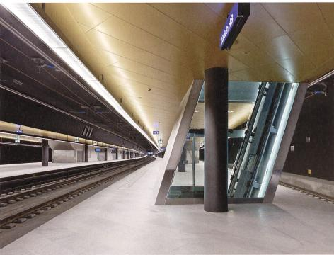
Vertikalverbindungen werden im Hauptbahnhof noch wichtiger als zuvor: Schräge Betonröhren verbinden die verschiedenen Ebenen miteinander. Von der alten Perronhalle (Bild oben) bis in den 16 Meter tiefer gelegenen Bahnhof Löwenstrasse (Bild unten).
