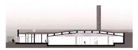
Längsschnitt durch die flache Kuppel des Gebetsraums
