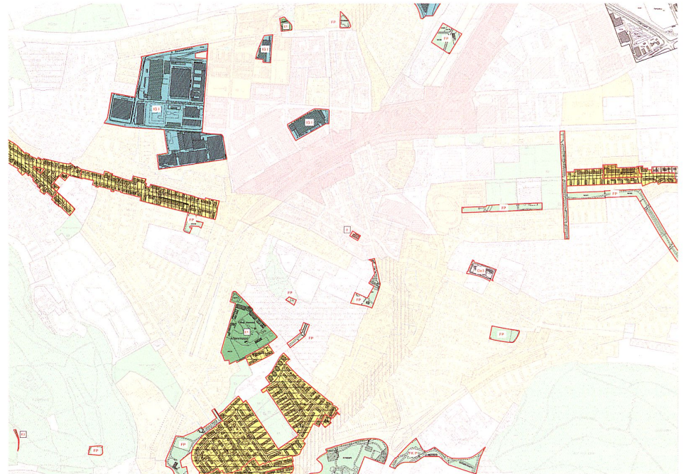
Teilrevision der BZO Zürich im Quartier Oerlikon. Blau: Gebiete mit obligatorischem Gewerbeanteil. Gelb mit vertikaler Schraffur: Strassenzüge mit erhöhter Ausnutzung und Wohnverbot im Erdgeschoss. Gelb mit horizontaler
